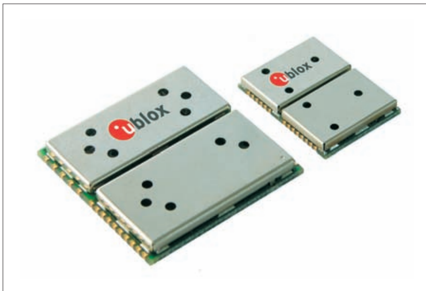
Рис. 2. Внешний вид GPS-модулей TIM-xx и LEA-xx
