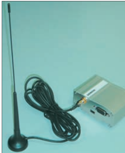
Рис. 5. Внешний вид GSM/GPRS/EDGE-терминала, выполненного на базе модуля MC75 Siemens Communications.
