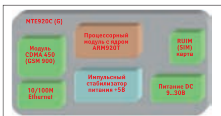
Рис. 3. Структурная схема шлюза MTE920G
