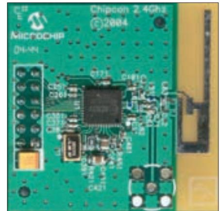
Рис. 1. Примеры монтажа трансивера CC2420 на переходную плату для отладочных целей
