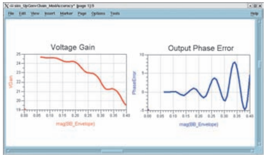
Рис. 12. Искажение коэффициента усиления по напряжению и фазовая погрешность выходного сигнала на выходе усилителя мощности при спиральной характеристике входного модулирующего сигнала
