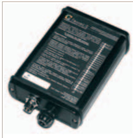
Рис. 2. Абонентский GSM/GPRS ПЛК регистратор данных «Геликс-2» в задачах активного мониторинга ТС и телеуправления
