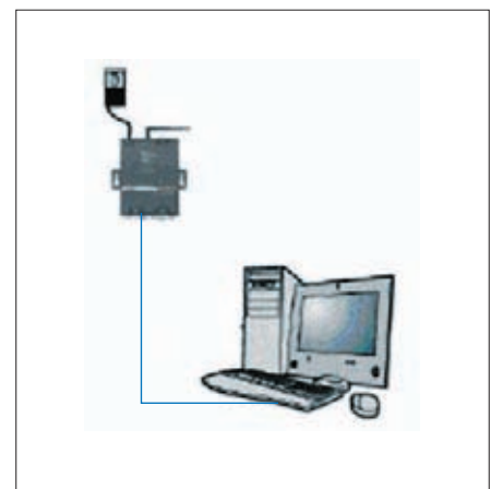
Рис. 6. Подключение WiBox к персональному компьютеру для начального конфигурирования
