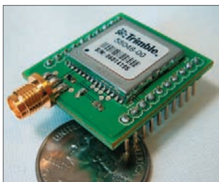
Рис. 3. Монтаж модуля на плату
