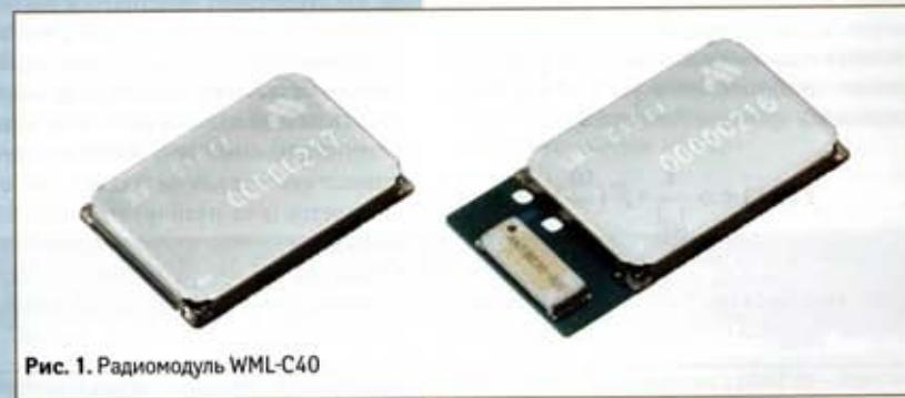
Рис. 1. Радиомодуль WML-C40
