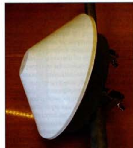
Рис. 10. Планарная отражательная антенна, расположенная в радиопрозрачном корпусе
