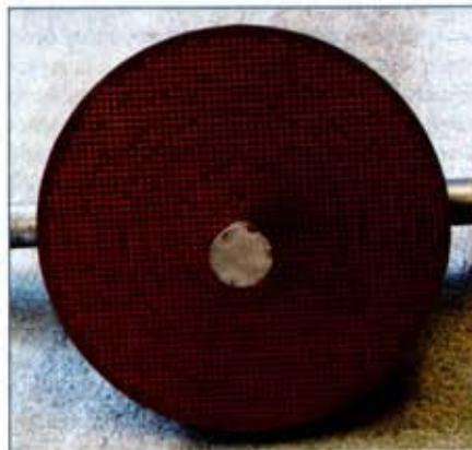
Рис. 8. Планарная печатная структура, обеспечивающая преобразование сферического фронта волны первичного излучателя без поворота плоскости поляризации в плоский фазовый фронт волны, излучаемой антенной
