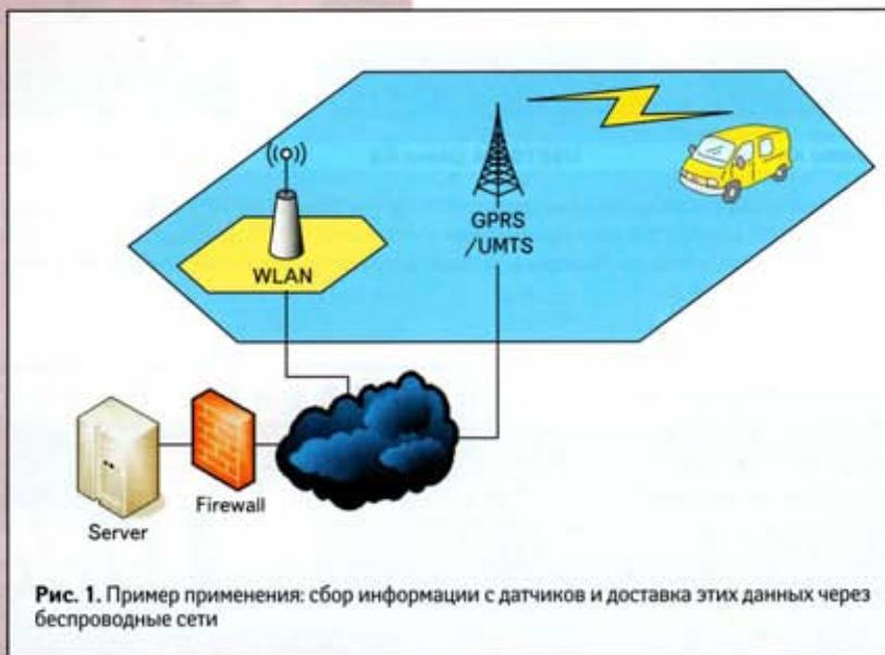
Рис. 1. Пример применения: сбор информации с датчиков и доставка этих данных через беспроводные сети
