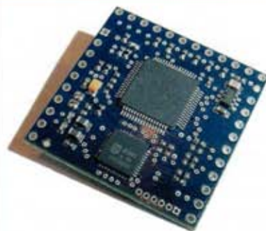
Рис. 11. Внешний вид модуля Arugon ACMA 13,56 МГц
