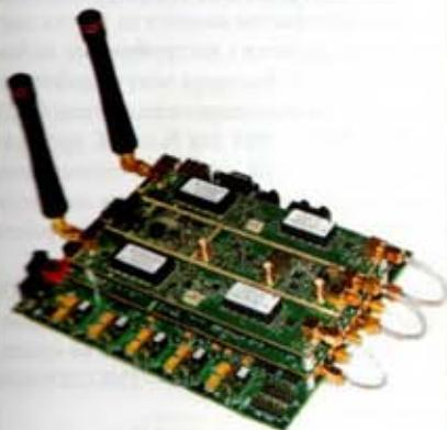
Рис. 5. Вид платформы SDR формата FFM фирмы Lyrtech
