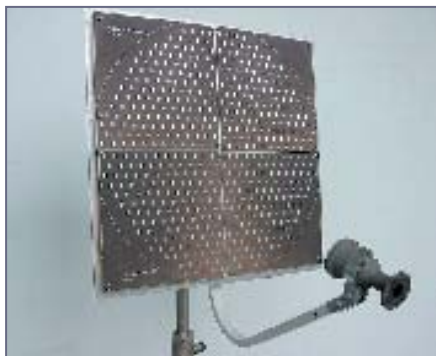
Рис. 7. Опытные образцы ФАР на частоту 12 ГГц, 532 излучателя с варакторами МА46Н120
