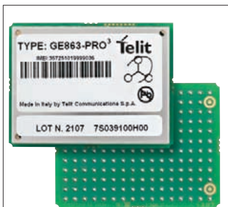
Рис. 3. Двухъядерный модуль GE863P-RO 3 компании Telit
