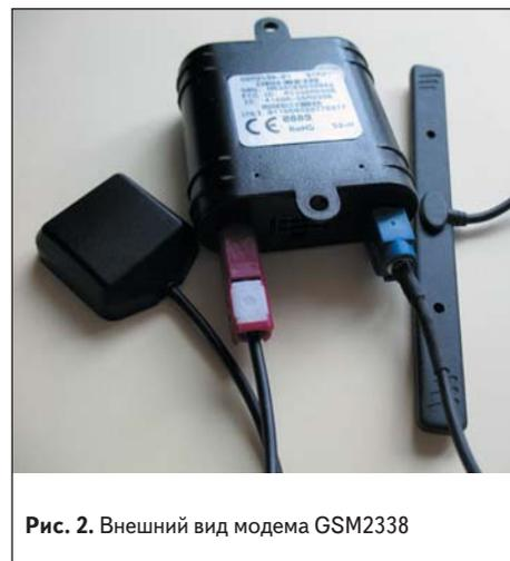
Рис. 2. Внешний вид модема GSM2338
