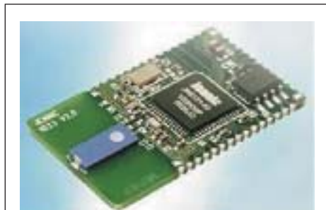
Рис. 2. Типовой модуль ZigBee фирмы Jennic
