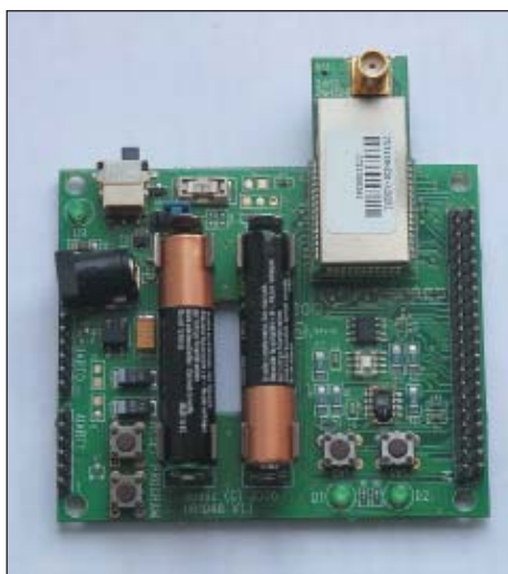
Рис. 4. Макетная плата узла с датчиками
