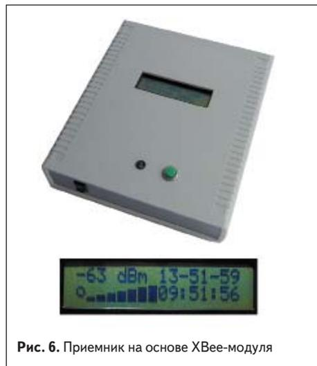
Рис. 6. Приемник на основе XBee-модуля
