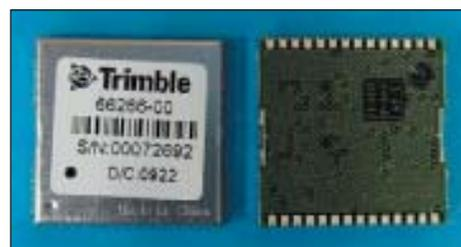
Рис. 2. GPS-модуль Resolution SMT 66266-00
