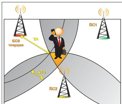
**Рис. 6.** Навигационное решение с использованием информации от 3 базовых станций различных операторов
