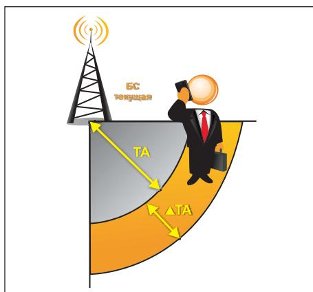
**Рис. 3** Навигационное решение без использования специализированных команд мониторинга сети
