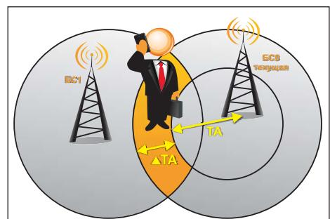
**Рис. 4** Навигационное решение с использованием информации от 2 базовых станций
