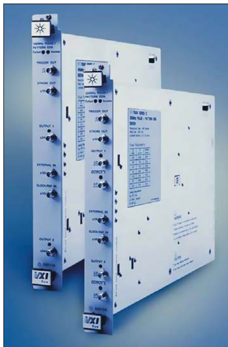
Рис. 16. Внешний вид генераторов E8311A/8312A, выполненных в формате VXI
