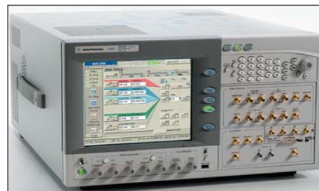
Рис. 18. Генератор Agilent J-BERT N4003B
