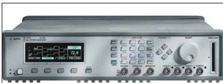
Рис. 15. Внешний вид генераторов серии 81XXX фирмы Agilent Technologies
