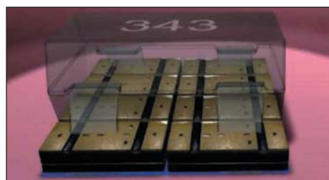
Рис. 4. Двадцать корпусов VMMK помещаются внутри корпуса SOT-343
