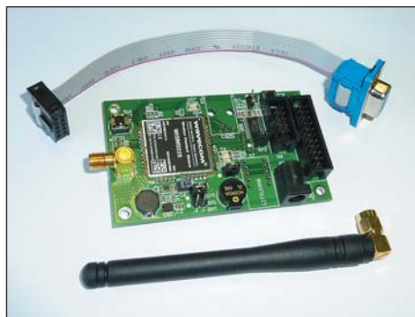
Рис. 1. Встраиваемый модуль TE-WISMO228
