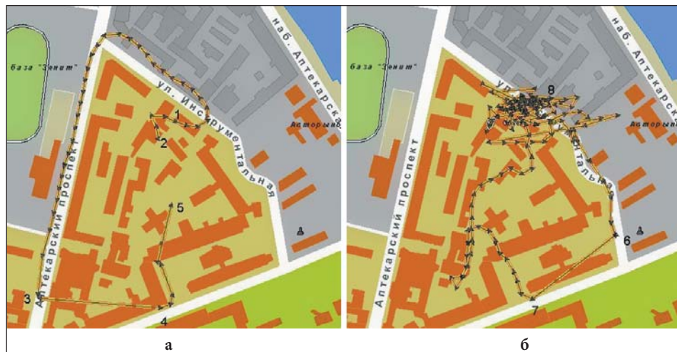
Рис. 8. Треки подвижного объекта, полученные при тестировании: а) датчика, содержащего модуль спутниковой навигации EV-500; б) датчика с модулем спутниковой навигации A1035-N
