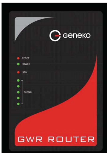
Рис. 4. Верхняя панель шлюза GWR
