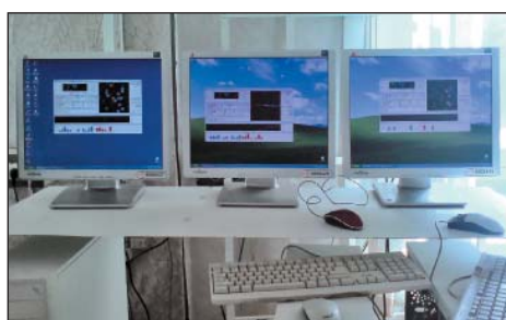
Рис. 18. Рабочее место для одновременного испытания трех ГЛОНАСС-модулей
