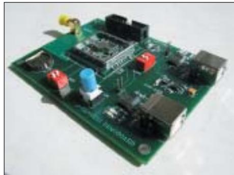
**Рис. 4. Демонстрационная плата NAVIA GPS-GLONASS DEMOBOARD**
