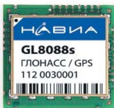
Рис. 1. ГЛОНАСС-модуль НАВИА GL8088s
