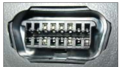
Рис. 4. Диагностическая колодка OBD-II
