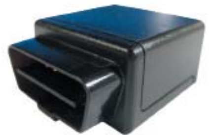
Рис. 3. Внешний вид модема MT3000 с автомобильным интерфейсом J1962, OBD-II
