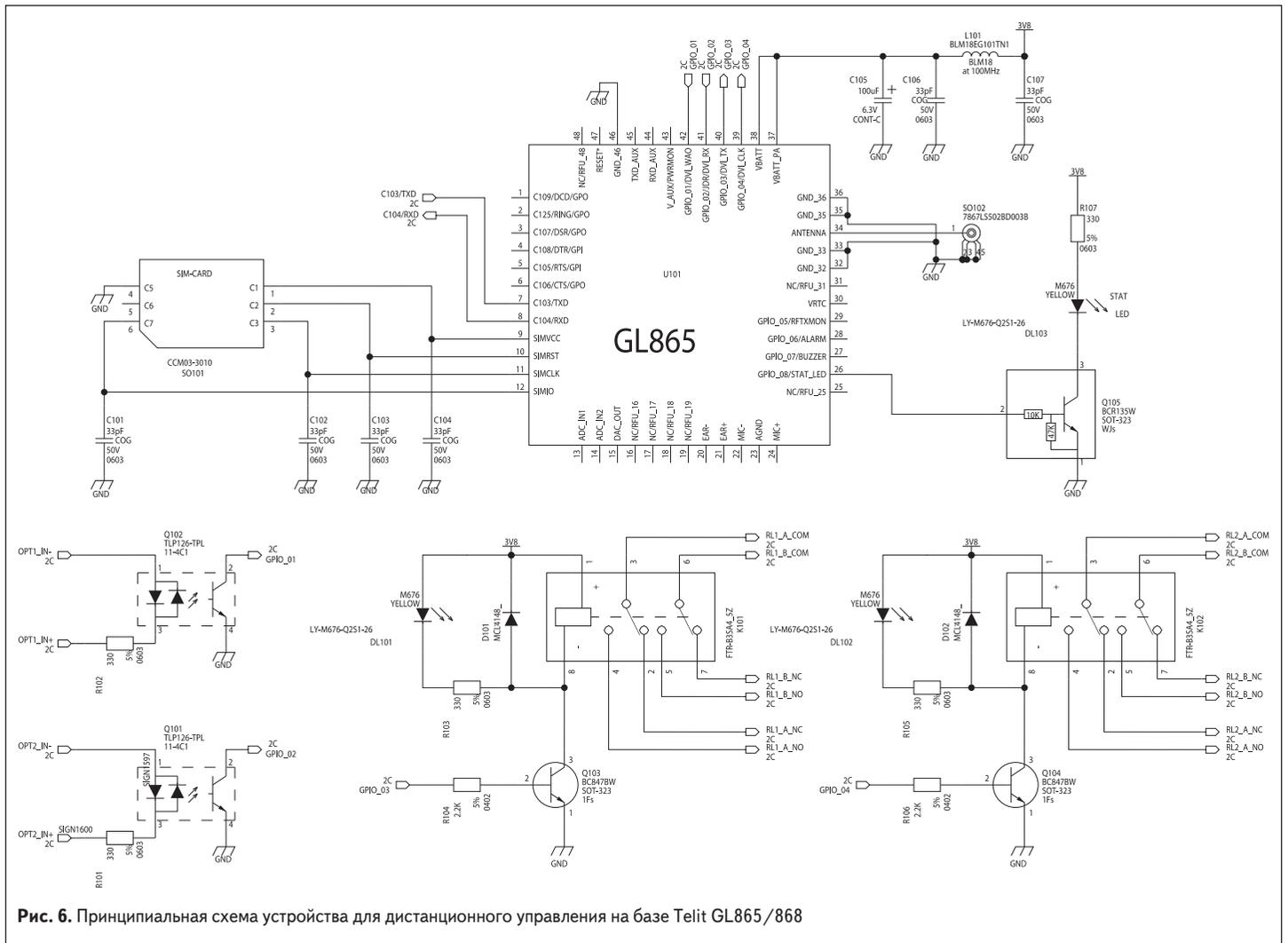
**Рис. 6.** Принципиальная схема устройства для дистанционного управления на базе Telit GL865/868
