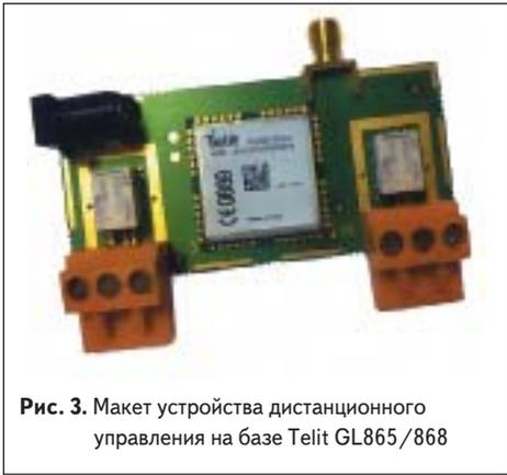
**Рис. 3.** Макет устройства дистанционного управления на базе Telit GL865/868
