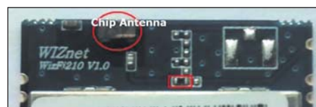
Рис. 9. Модификация модуля WizFi210 со встроенной чип-антенной, высокочастотный сигнал на которую подается с помощью резистора с нулевым сопротивлением
