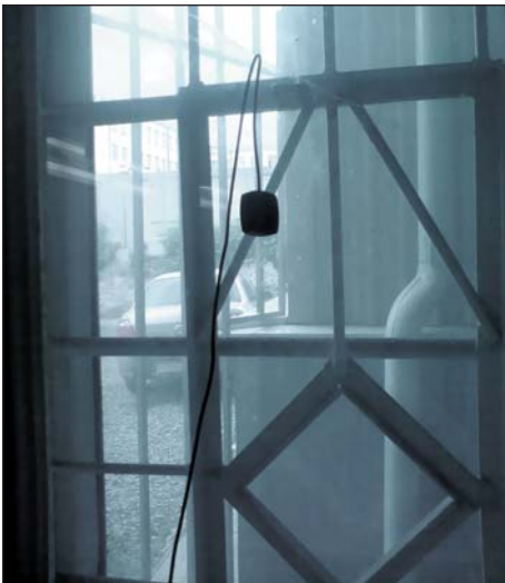
Рис. 4. Закрепленная на окне ГЛОНАСС/GPS-антенна
