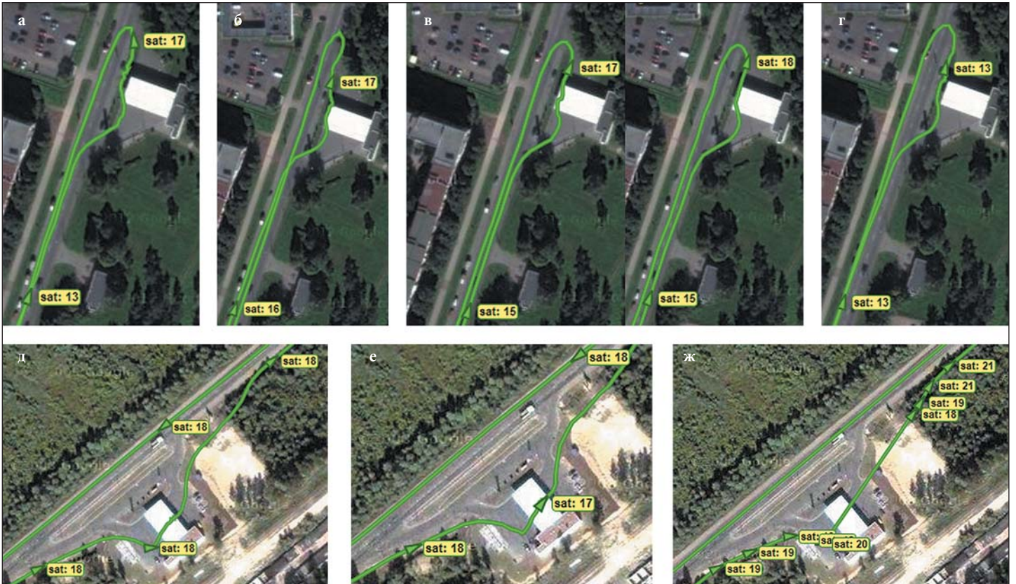
Рис. 13. Крытая АЗС: а) L16, ежесекундно; б) MGS 2217, ежесекундно; в) два NV08C, ежесекундно; г) MGS 2217, ежесекундно; д) MGS 2217, ежесекундно; е) MGS 2217, ежесекундно; ж) L16, стандартная детализация
