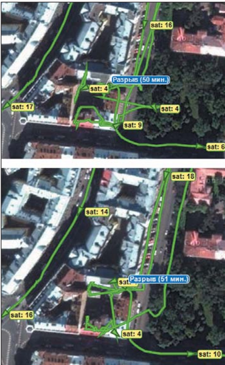
Рис. 8. Парковка и старт во дворе-колодце с полным выключением питания (оборудование было перенесено на другое авто, расположенное в этом же дворе на расстоянии 5 м), MGS 2217, ежесекундно
