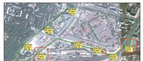
Рис. 3. ГЛОНАСС/GPS-приемник Ижевского радиозавода МНП-М7, 2011 г. Пример «ненормального» трека
