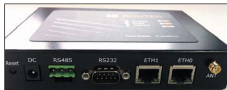
Рис. 1. Внешний вид шлюза S1901-3G
