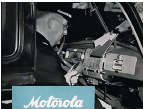
Рис. 2. Радиостанция T6920 в полицейском автомобиле
