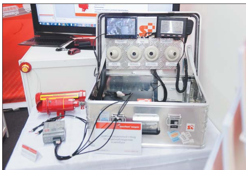
Рис. 2. Комплексная система безопасности пассажирских перевозок на наземном транспорте «Транспорт-Видео»
