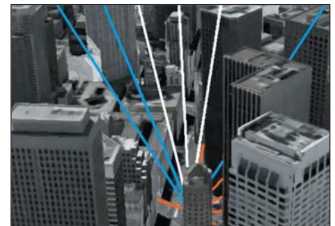
Рис. 11. Сигналы спутников, доступные ГНСС-приемнику, окруженному высотными зданиями
