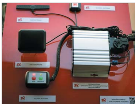
Рис. 3. Тестирование оборудования «ЭРА-ГЛОНАСС»
