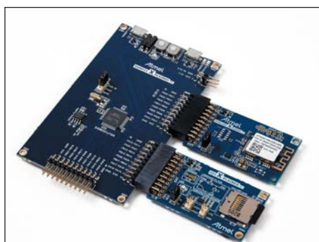
Рис. 3. Отладочный комплект ATWINC1500-XSTK содержит основную плату SAMD21 Xplained Pro и платы расширения WINC1500 и IO1 (с датчиками и SD-картой)
