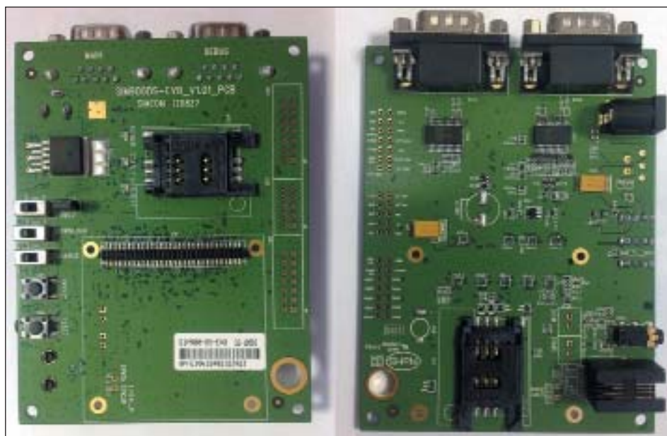
Рис. 4. Лицевая и обратная сторона отладочной платы SIM900-DS-EVB
