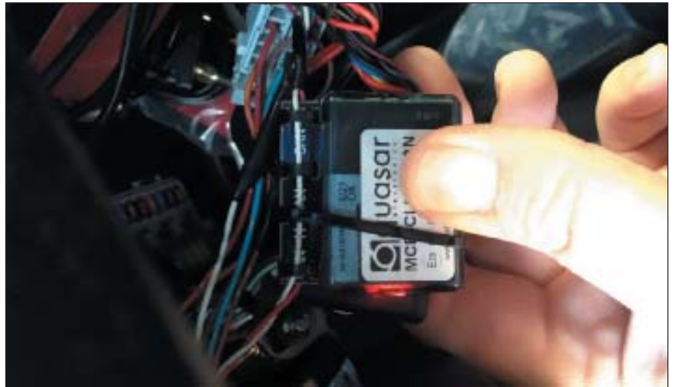
Рис. 2. Бесконтактное подключение к CAN-шине с помощью адаптера MCB ClickCan
