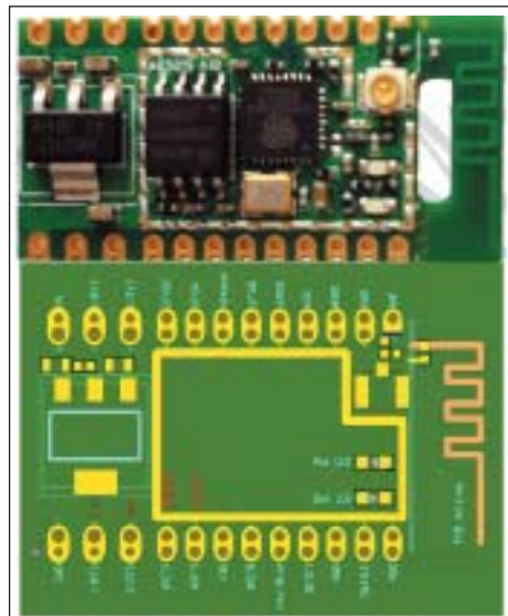
Рис. 3. Внешний вид и назначение выводов модуля A6501S
