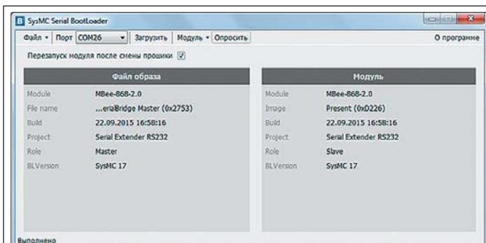
Рис. 9. Обновление прошивки через SysMC Serial BootLoader
