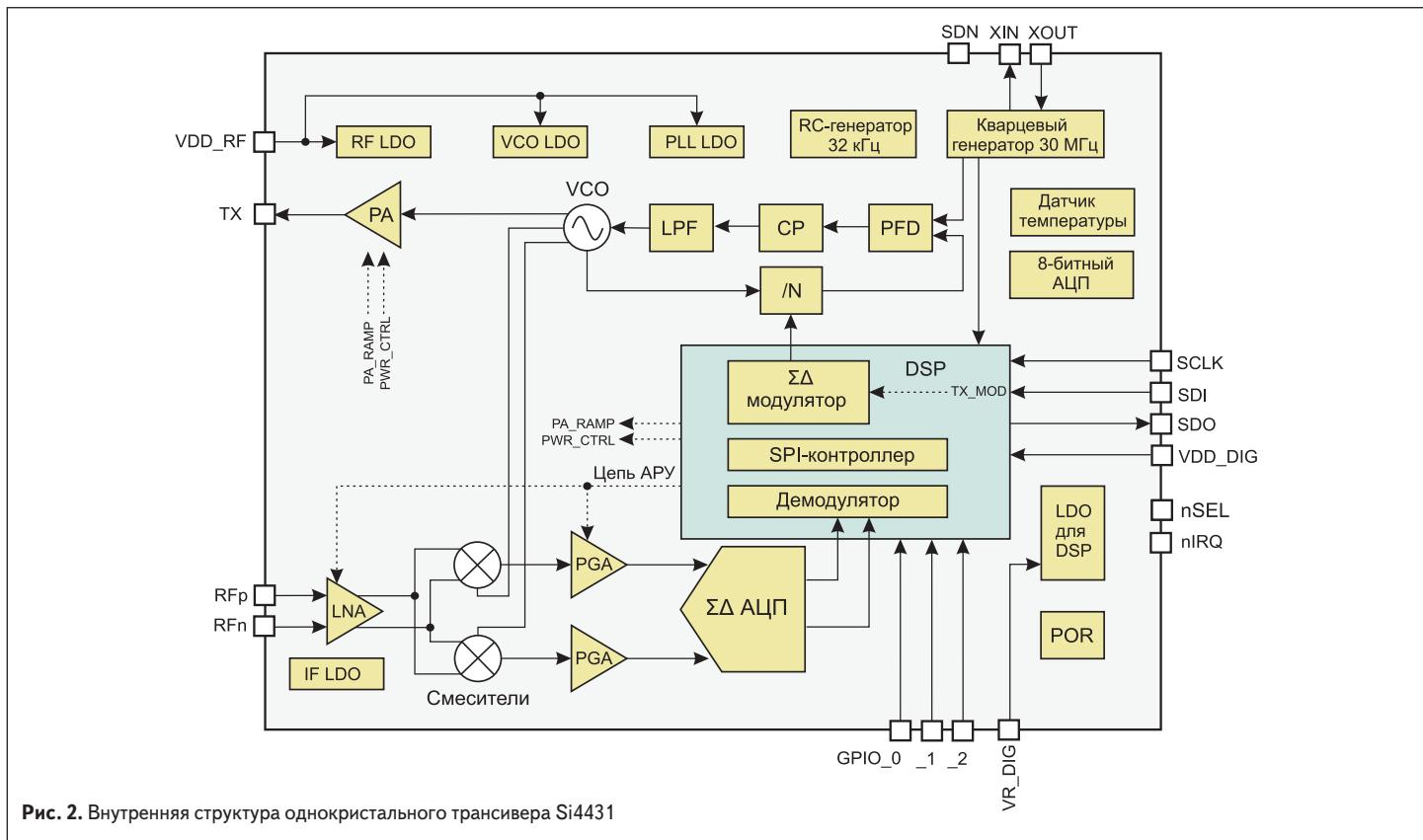
распространение в современных однокристальных решениях, поскольку позволяет реализовать лучшие характеристики радиоприемного тракта в плане чувствительности и избирательности по соседнему каналу по сравнению со схемой прямого преобразования.
