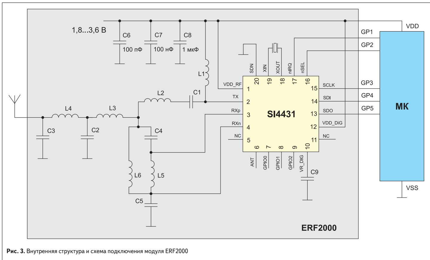
и индикации мощности принимаемого сигнала (RSSI) с разрешением 0,5 дБ. Параметры цифрового фильтра зависят от заданного вида модуляции, его полоса пропускания программируется в пределах от 2,6 до 620 кГц. Обработанное значение демодулированного сигнала может быть передано на управляющий микроконтроллер посредством последовательного интерфейса связи SPI.
