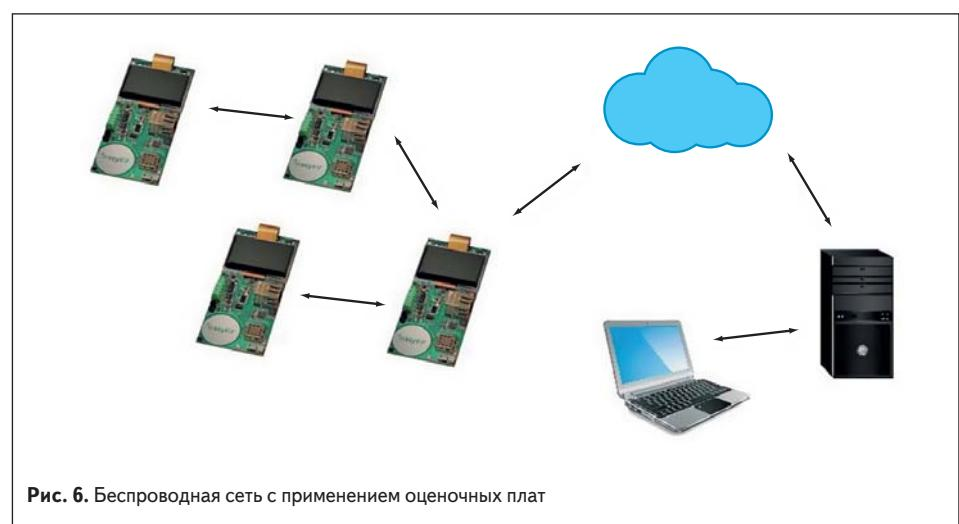
**Рис. 6.** Беспроводная сеть с применением оценочных плат
