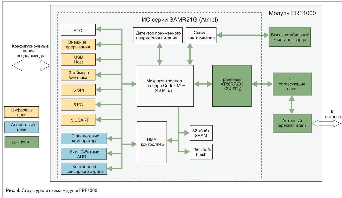
Рис. 4. Структурная схема модуля ERF1000
