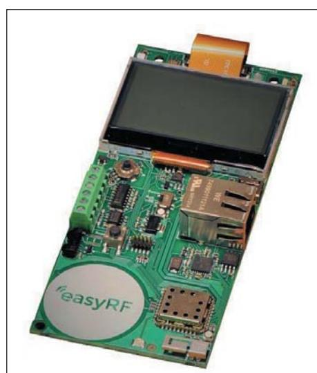
Рис. 5. Внешний вид отладочной платы на базе модуля ERF1000
