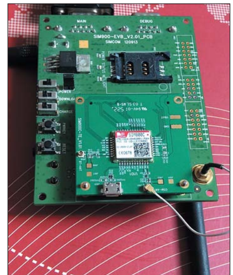
Рис. 7. Отладочный набор для GSM/GPRS-модуля SIM800C
