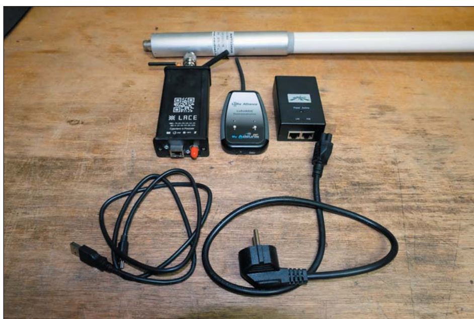
Рис. 2. Тестовые устройства, входящие в измерительный комплекс: антенна, БС, передатчик, регистратор
