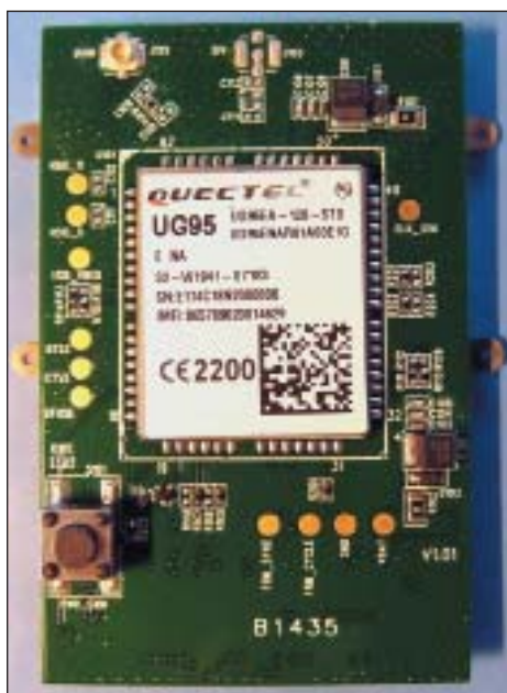
Рис. 18. Внешний вид отладочной платы UG95-TE-A QUECTEL
