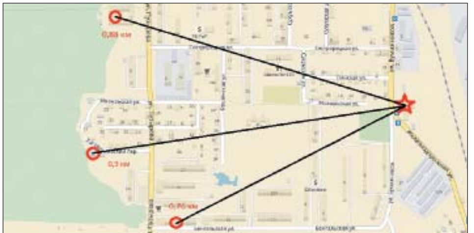
Рис. 11. Карта микрорайона с указанием мест установки БС (отмечено звездочкой) и датчиков
