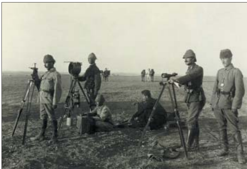
Рис. 6. Подразделение оптической связи армии Османской империи перед столкновением с 5-й горнострелковой бригадой Британского египетского экспедиционного корпуса в Палестине (the Affair of Huj, 8 November 1917). На вооружении подразделения: гелиограф (у первого слева), ацетиленовый прожектор (у второго слева) и подзорная труба (у второго справа)
