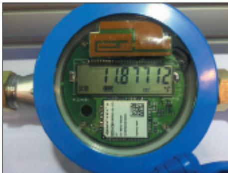
Рис. 1. Беспроводной интеллектуальный датчик расхода воды на базе модуля BC95
