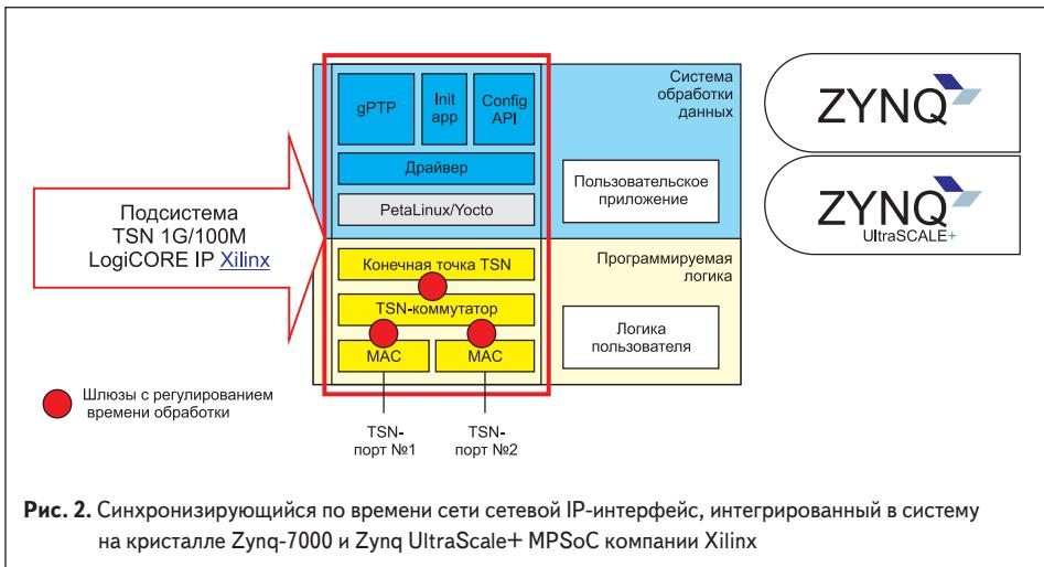
Рис. 2. Синхронизирующийся по времени сети сетевой IP-интерфейс, интегрированный в систему на кристалле Zynq-7000 и Zynq UltraScale+ MPSoC компании Xilinx
