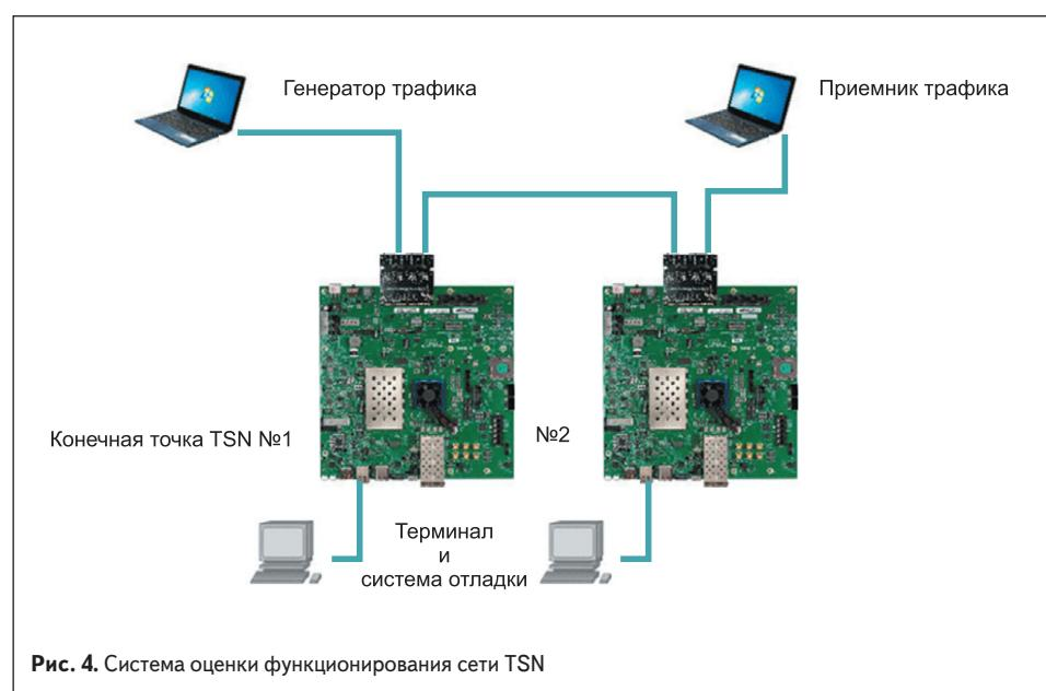
**Рис. 4.** Система оценки функционирования сети TSN
