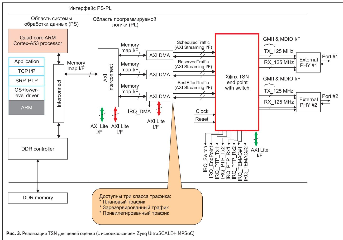
Рис. 3. Реализация TSN для целей оценки (с использованием Zynq UltraSCALE+ MPSoC)
