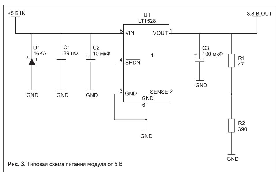
**Рис. 3.** Типовая схема питания модуля от 5 В
