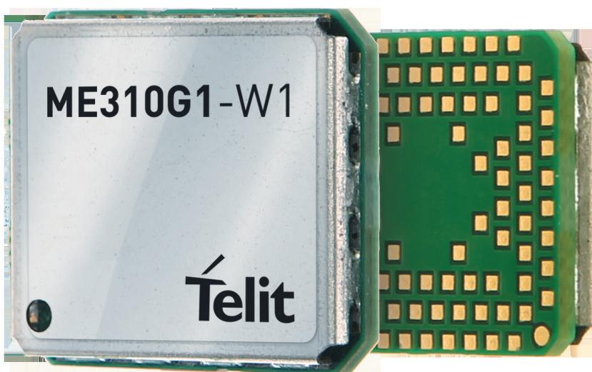
**Рис. 1.** Модуль Telit ME310G1-W1
