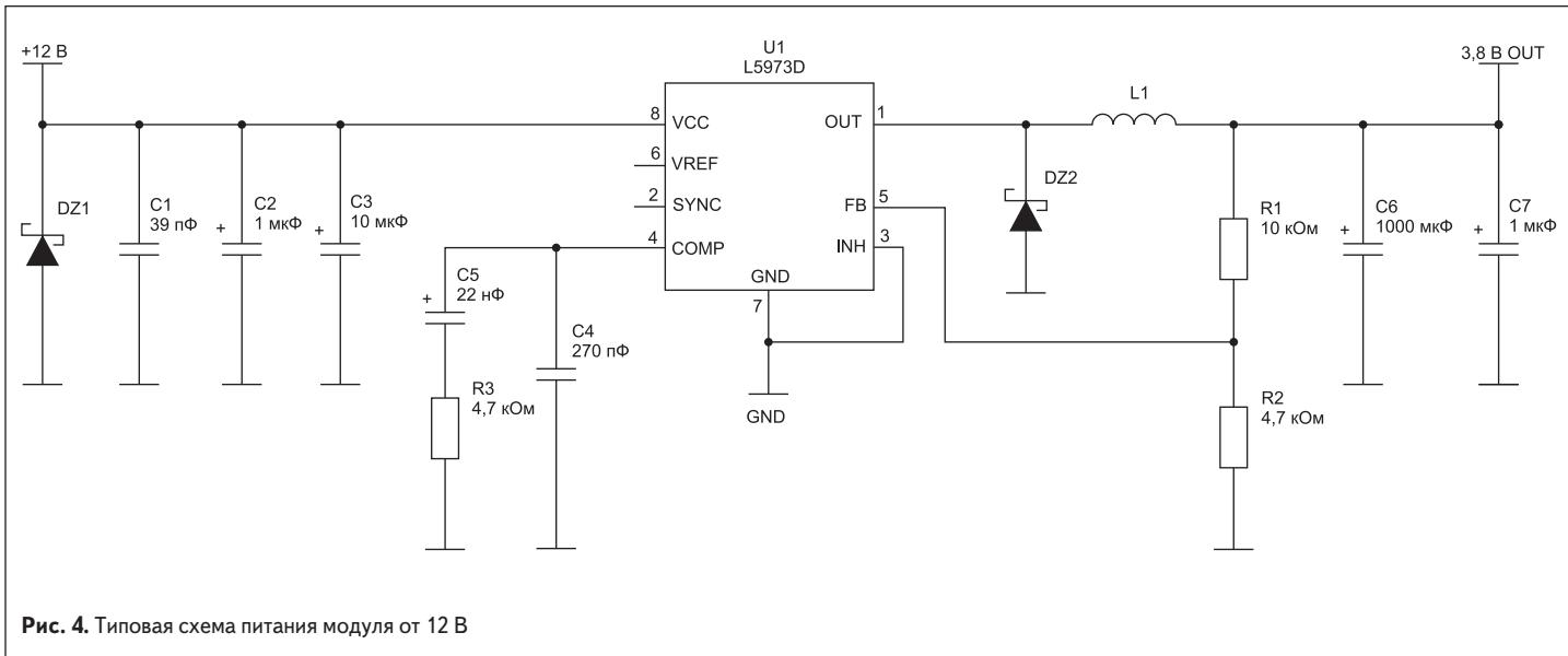
Рис. 4. Типовая схема питания модуля от 12 В
